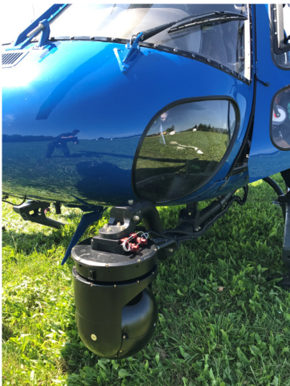
Kreisstabilisierte Kamera mit Wärmebildsensor
