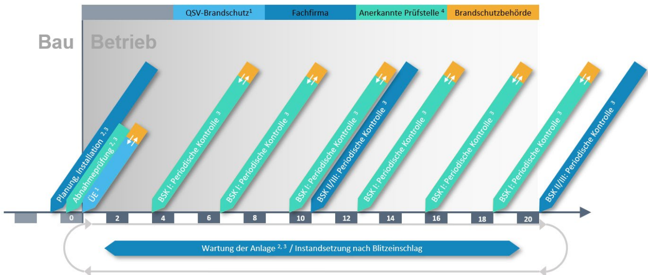
Abbildung 4: Nötige Meilensteine für Planung und Betrieb von Blitzschutzsystemen (BSS) (die Ziffern verweisen auf die nachfolgenden Rechtsgrundlagen)
