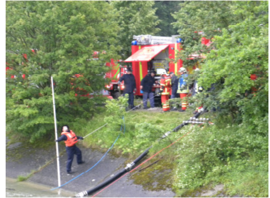
Ermittlung der effektiven Ansaughöhe
